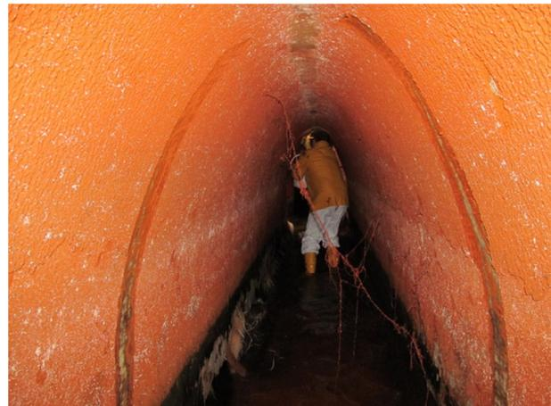
**Entnahme von Probenmaterial für die Deklarationsuntersuchungen an mehreren Einstiegen pro Abschnitt**
