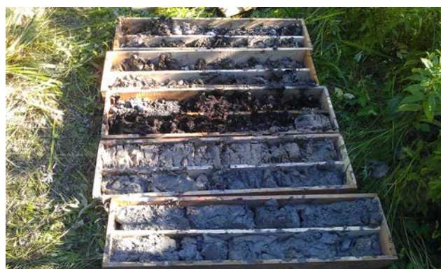
Exemplarisch, aufgeschlossene Schichten der Bohrung B 2: Auffüllung – Torf – Schluff – Ton (Seeton)
